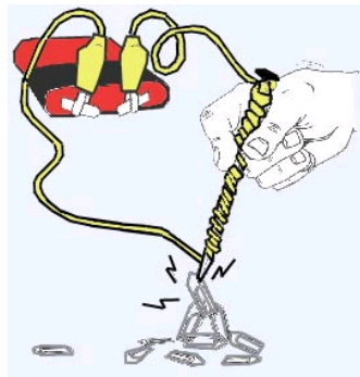
Abbildung 3-1: Strom erzeugt ein Magnetfeld
